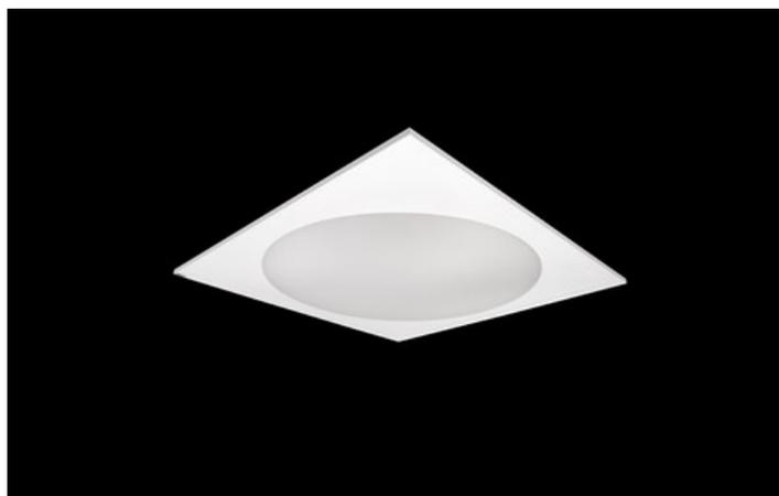
Innenbeleuchtung. Montage: Einbauleuchte für Deckenmontage (fakultativ: Deckenanbaurahmen, Rahmen für Gipskartondecken). Gehäuse aus Aluminium. Arbeitstemperaturbereich:  $5 \div 30^{\circ} \text{C}$ . Stoßfestigkeitsgrad: IK04. Schutzklasse: II.
