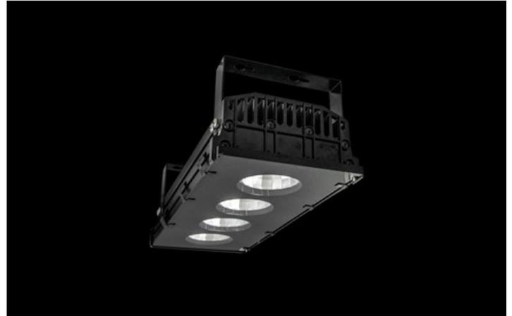
Innenbeleuchtung. Montage: Anbau an der Decke oder an Aufhängebügeln. Gehäuse aus Aluminium. Arbeitstemperaturbereich:  $-25 \div 40^\circ \text{C}$ . Stoßfestigkeitsgrad: IK08. Schutzklasse: I.
