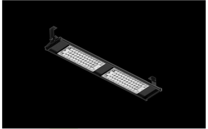
Außenbeleuchtung. Montage: Mastmontage; Anbau an der Decke oder an Aufhängebügeln. Gehäuse aus Aluminium. Arbeitstemperaturbereich:  $-25 \div 40^{\circ}$  C. Stoßfestigkeitsgrad: IK08. Schutzklasse: I.
