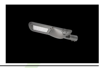
Außenbeleuchtung. Montage: Mastmontage. Gehäuse aus Aluminium. Arbeitstemperaturbereich: -40 ÷ 40° C. Stoßfestigkeitsgrad: IK09. Schutzklasse: I. Die Leuchte ist mit einem verstellbaren Griff ausgestattet, der für die Montage an Masten und Armen mit einem Durchmesser von 60 mm vorgesehen ist. Optionale Griffe sind auch für die Montage an Masten mit Enddurchmessern von 32 mm bis 76 mm erhältlich. \*Ausgewählte Leuchtenvarianten sind mit ENEC-Zertifikat erhältlich.
