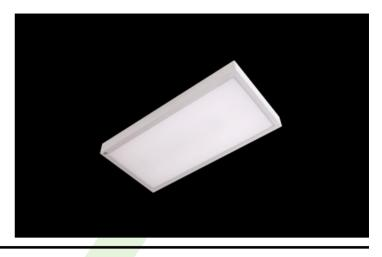
Innenbeleuchtung. Montage: Anbau an der Decke. Gehäuse aus Stahlblech. Arbeitstemperaturbereich: 5 ÷ 30° C. Stoßfestigkeitsgrad: IK04. Schutzklasse: I.
