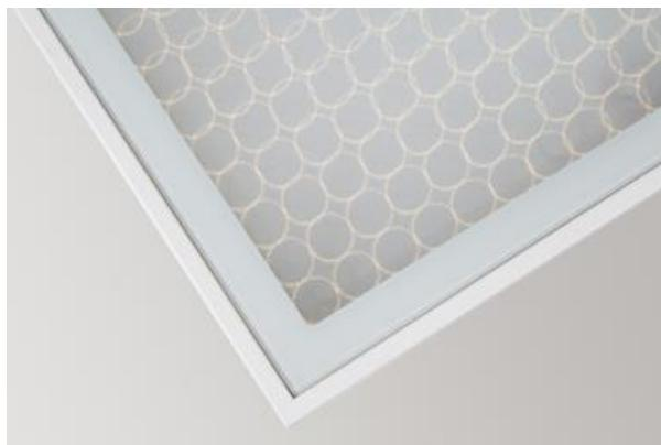
Innenbeleuchtung. Montage: Anbau an der Decke. Gehäuse aus Stahlblech. Arbeitstemperaturbereich: 5  $\div$  30° C. Stoßfestigkeitsgrad: IK08. Schutzklasse: I. Abdeckung rahmenlos aus Verbundglas – Scheibe, mit komfortablen Magnetverschlüssen. Dies ist ein Medizinprodukt. Verwenden Sie es in Übereinstimmung mit der Gebrauchsanweisung.
