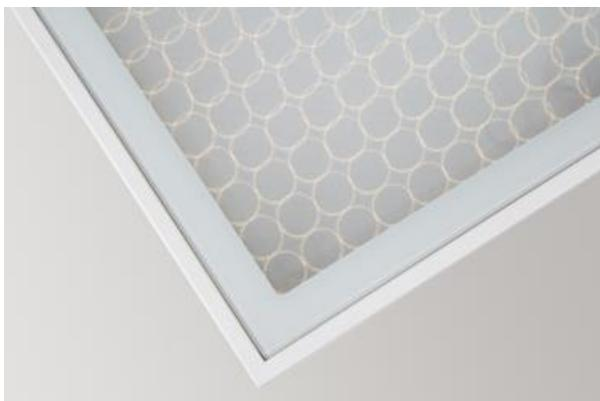
Innenbeleuchtung. Leuchte für Einsatz in Reinräumen mit erhöhten Reinheitsklassen ISO 3-4. Montage: Anbau an der Decke. Gehäuse aus Stahlblech. Arbeitstemperaturbereich:  $5 \div 30^{\circ} \text{C}$ . Stoßfestigkeitsgrad: IK08. Schutzklasse: I. Abdeckung rahmenlos aus Verbundglas – Scheibe, mit komfortablen Magnetverschlüssen.
