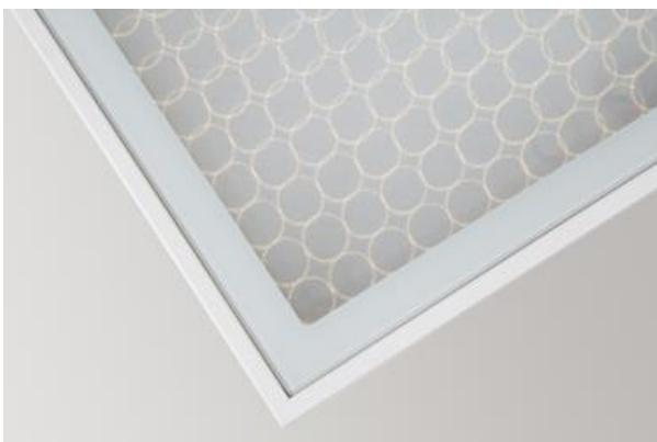
Innenbeleuchtung. Leuchte für Einsatz in Reinräumen mit erhöhten Reinheitsklassen ISO 5-6. Montage: Anbau an der Decke. Gehäuse aus Stahlblech. Arbeitstemperaturbereich:  $5 \div 30^{\circ} \text{C}$ . Stoßfestigkeitsgrad: IK08. Schutzklasse: I. Abdeckung rahmenlos aus 4mm ESG-Einscheibensicherheitsglas-Scheibe, mit komfortablen Magnetverschlüssen.
