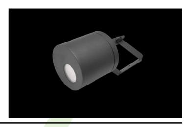
Außenbeleuchtung. Montage: Deckenmontage oder Wandmontage. Gehäuse aus Aluminium. Arbeitstemperaturbereich: -25 ÷ 30° C. Stoßfestigkeitsgrad: IK02. Schutzklasse: I. Die Leuchte ist mit einem PIR-Bewegungssensor (Passiv-Infrarot) ausgestattet. Anzahl der Einund Ausschaltzyklen des Sensors größer als 100000.
