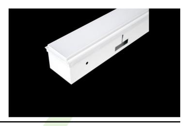
Innenbeleuchtung. Montage: Einbauleuchte für Deckenmontage (Gipskartondecken). Gehäuse aus Stahlblech. Arbeitstemperaturbereich: 5 ÷ 30° C. Stoßfestigkeitsgrad: IK04. Schutzklasse: I.
