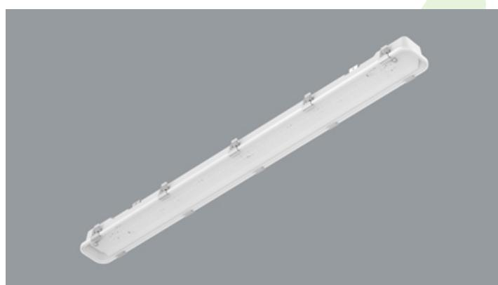
Innenbeleuchtung. Montage: Anbau an der Decke oder an Aufhängebügeln. Gehäuse aus austenitischer rostfreier Stahl INOX A2 (AISI 304). Arbeitstemperaturbereich: -25  $\div$  35° C. Stoßfestigkeitsgrad: IK08. Schutzklasse: I.
