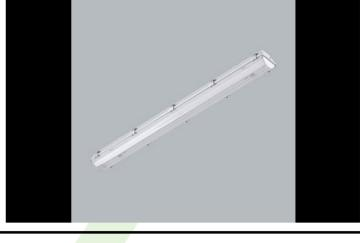
Innenbeleuchtung. Montage: Anbau an der Decke oder an Aufhängebügeln. Gehäuse aus Polycarbonat. Arbeitstemperaturbereich: -40 ÷ 35° C. Stoßfestigkeitsgrad: IK10. Schutzklasse: I.
