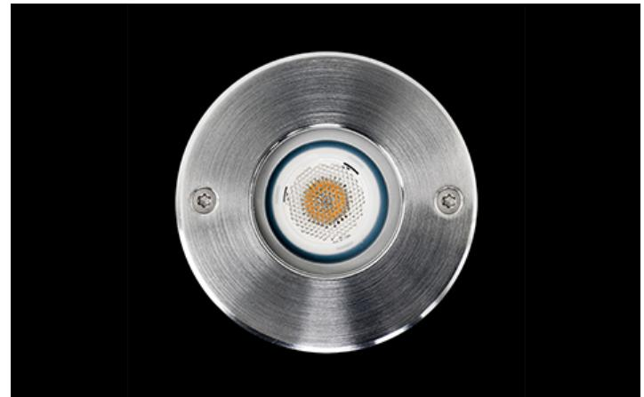
Außenbeleuchtung. Montage: im Boden. Gehäuse aus Aluminium / Rostfreier Stahl. Arbeitstemperaturbereich: -20  $\div$  35° C. Stoßfestigkeitsgrad: IK08. Schutzklasse: I.
