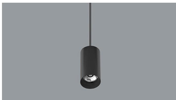
Innenbeleuchtung. Montage: an Aufhängebügeln von den abgehängten Decken. Gehäuse aus Aluminium. Arbeitstemperaturbereich: 5 ° C. Stoßfestigkeitsgrad: IK04. Schutzklasse: III.
