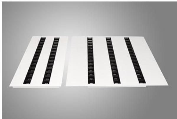
Innenbeleuchtung. Montage: Einbau in Moduldecken sowie Gipskartondecken, direkte Montage an der Deckenkonstruktion und Aufbaumontage an Abhänger mittels Zubehör. Gehäuse aus Stahlblech. Arbeitstemperaturbereich: 5  $\div$  30° C. Stoßfestigkeitsgrad: IK04. Schutzklasse: II.
