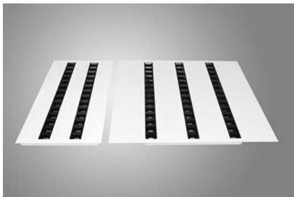
Innenbeleuchtung. Montage: Einbau in Moduldecken sowie Gipskartondecken, direkte Montage an der Deckenkonstruktion und Aufbaumontage an Abhänger mittels Zubehör. Gehäuse aus Stahlblech. Arbeitstemperaturbereich: 5 °C bis 30 °C. Stoßfestigkeitsgrad: IK04. Schutzklasse: II.
