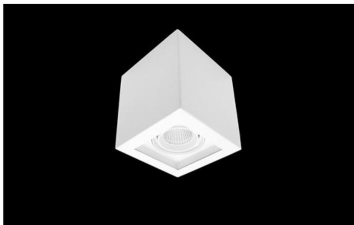
Innenbeleuchtung. Montage: Anbau an der Decke. Gehäuse aus Aluminium. Arbeitstemperaturbereich: 5 ÷ 30° C. Stoßfestigkeitsgrad: IK04. Schutzklasse: I. Die Farbe des Rahmens und des Gehäuses hat einen etwas anderen Farbton als die innere Reflektorabdeckung.
