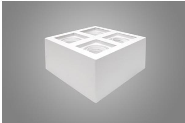
Innenbeleuchtung. Montage: Anbau an der Decke. Gehäuse aus Aluminium. Arbeitstemperaturbereich: 5 ÷ 30° C. Stoßfestigkeitsgrad: IK04. Schutzklasse: I. Die Farbe des Rahmens und des Gehäuses hat einen etwas anderen Farnton als die innere Reflektorabdeckung.
