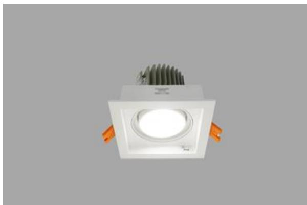
Innenbeleuchtung. Montage: in Moduldecken und Gipskartondecken. Gehäuse aus Aluminium. Arbeitstemperaturbereich: 5 ° – 30 ° C. Stoßfestigkeitsgrad: IK04. Schutzklasse: II. Die Farbe des Rahmens und des Gehäuses hat einen etwas anderen Farbton als die innere Reflektorabdeckung.
