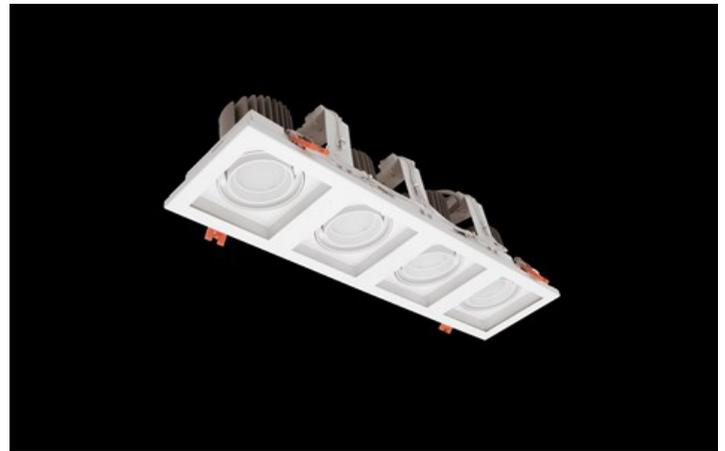
Innenbeleuchtung. Montage: Einbauleuchte für Deckenmontage. Gehäuse aus Aluminium. Arbeitstemperaturbereich:  $5 \pm 30^\circ \text{C}$ . Stoßfestigkeitsgrad: IK04. Schutzklasse: I. Die Farbe des Rahmens und des Gehäuses hat einen etwas anderen Farbton als die innere Reflektorabdeckung.
