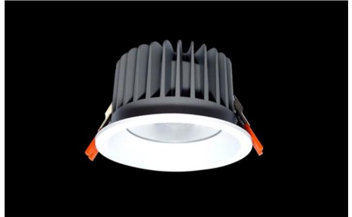
Innenbeleuchtung. Montage: in Moduldecken und Gipskartondecken. Gehäuse aus Aluminium. Arbeitstemperaturbereich: 5 ÷ 30° C. Stoßfestigkeitsgrad: IK04. Schutzklasse: II.
