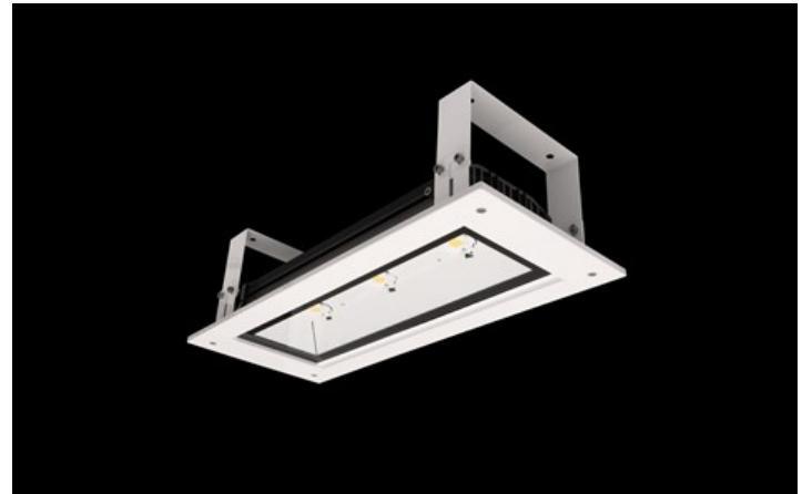
Außenbeleuchtung. Montage: Einbau in abgehängte Decken. Gehäuse aus Aluminium. Arbeitstemperaturbereich: -25 ° C. bis +40 ° C. Stoßfestigkeitsgrad: IK08. Schutzklasse: I. Die externe Anwendung ist möglich, da das Produkt mit einem Druckausgleichsventil ausgestattet ist und das Gehäuse eine spezielle Lackierung aufweist, die an die äußeren Bedingungen angepasst ist.
