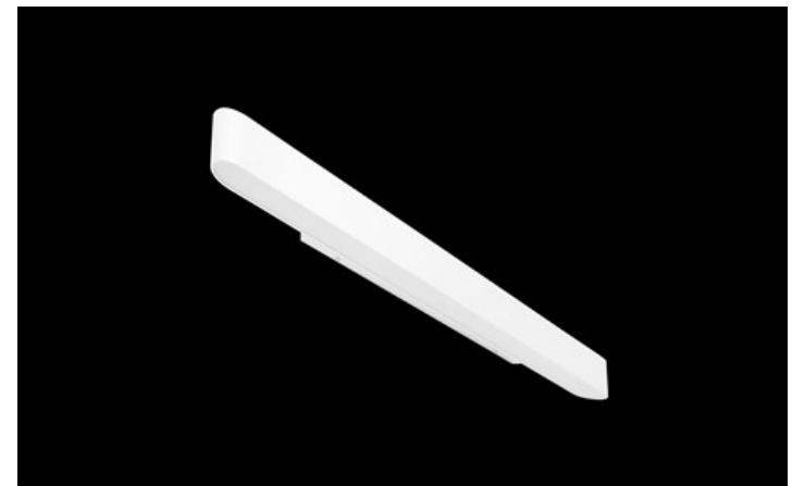
Innenbeleuchtung. Montage: Wandleuchte. Gehäuse aus Aluminium. Arbeitstemperaturbereich: 0 ÷ 30° C. Stoßfestigkeitsgrad: IK04. Schutzklasse: I. Die Leuchten zeichnen sich durch eine dicht abgeschlossene Kammer mit Leuchtdioden (IP65), wodurch sogar bei einer langen Nutzungsdauer auf der Blende keine Verschmutzungen zu sehen sind. Temperaturbereich für Lagerung und Transport von 0° C bis 40° C.
