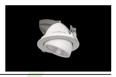
Innenbeleuchtung. Montage: in abgehängter Decke. Gehäuse aus Aluminium. Arbeitstemperaturbereich:  $5 \div 35^\circ$  C. Stoßfestigkeitsgrad: IK04. Schutzklasse: II.
