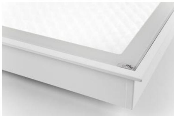
Innenbeleuchtung. Montage: in Moduldecken und Gipskartondecken. Gehäuse aus Stahlblech. Arbeitstemperaturbereich:  $5 \div 30^\circ \text{C}$ . Stoßfestigkeitsgrad: IK04. Schutzklasse: I. \*Ausgewählte Leuchtenvarianten sind mit ENEC-Zertifikat erhältlich.
