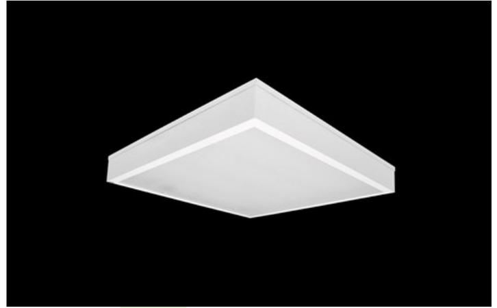
Innenbeleuchtung. Montage: in Moduldecken. Gehäuse aus Stahlblech. Arbeitstemperaturbereich:  $5 \div 30^\circ \text{C}$ . Stoßfestigkeitsgrad: IK04. Schutzklasse: I.
