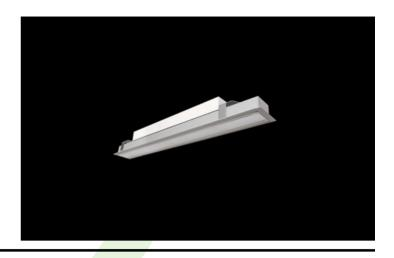
Innenbeleuchtung. Montage: Einbauleuchte für Deckenmontage (Gipskartondecken). Gehäuse aus Aluminium. Arbeitstemperaturbereich: 5 ÷ 35° C. Stoßfestigkeitsgrad: IK04. Schutzklasse: I.
