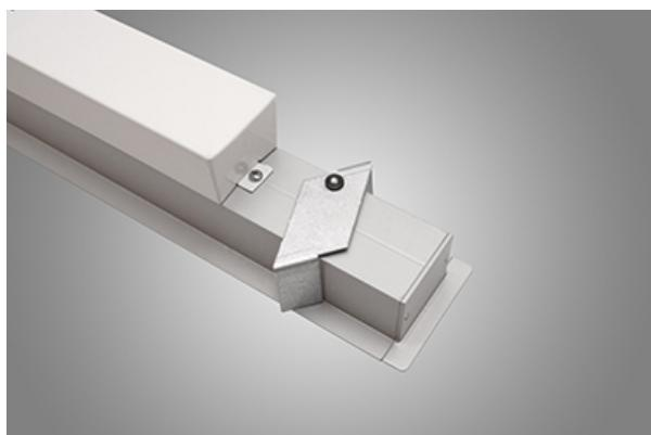
Innenbeleuchtung. Montage: Einbauleuchte für Deckenmontage (Gipskartondecken). Gehäuse aus Aluminium. Arbeitstemperaturbereich: 5  $\div$  35° C. Stoßfestigkeitsgrad: IK04. Schutzklasse: I.
