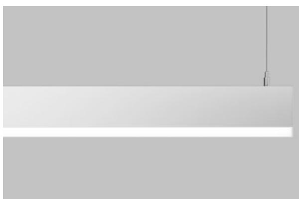
Innenbeleuchtung. Montage: an Aufhängebügeln. Gehäuse aus Aluminium. Arbeitstemperaturbereich: 5 ° bis 35 ° C. Stoßfestigkeitsgrad: IK04. Schutzklasse: I. Ausgewählte Leuchtenvarianten können mit einem schallabsorbierenden Gehäuse ausgestattet werden.
