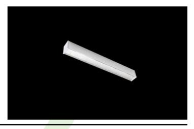
Innenbeleuchtung. Montage: Anbau an der Decke oder an Aufhängebügeln mit Zubehör. Gehäuse aus Aluminium. Arbeitstemperaturbereich: 5 ÷ 30° C. Stoßfestigkeitsgrad: IK04. Schutzklasse: I.
