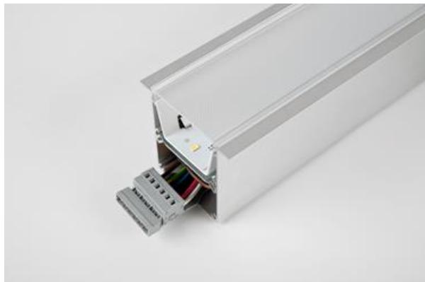
Innenbeleuchtung. Montage: Einbauleuchte für Deckenmontage (Gipskartondecken). Gehäuse aus Aluminium. Arbeitstemperaturbereich: 5 ° C bis 30 ° C. Stoßfestigkeitsgrad: IK04. Schutzklasse: I.
