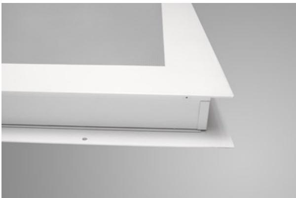
Innenbeleuchtung. Montage: in abgehängter Decke. Gehäuse aus Stahlblech. Arbeitstemperaturbereich:  $5 \div 30^{\circ}$  C. Stoßfestigkeitsgrad: IK04. Schutzklasse: I.
