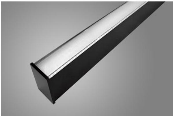
Innenbeleuchtung. Montage: Anbau an Aufhängebügeln. Gehäuse aus Aluminium. Arbeitstemperaturbereich:  $5 \div 30^{\circ} \text{C}$ . Stoßfestigkeitsgrad: IK04. Schutzklasse: I. Stromanschluss erfolgt nur über eine mit EL gekennzeichnete Leuchte.
