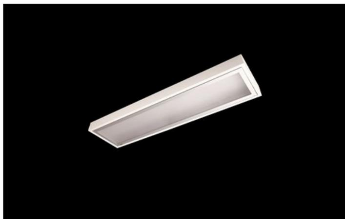
Innenbeleuchtung. Montage: Anbau an der Decke. Gehäuse aus Stahlblech. Arbeitstemperaturbereich:  $5 \pm 30^\circ \text{C}$ . Stoßfestigkeitsgrad: IK08. Schutzklasse: I.
