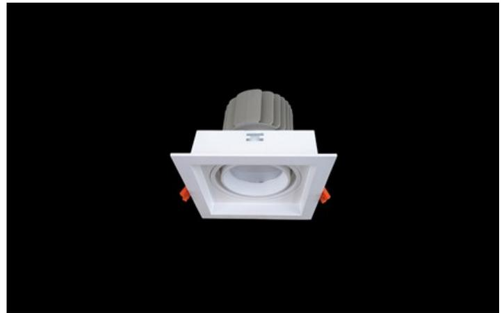
Innenbeleuchtung. Montage: Einbauleuchte für Deckenmontage. Gehäuse aus Aluminium. Arbeitstemperaturbereich: 5 ÷ 30° C. Stoßfestigkeitsgrad: IK04. Schutzklasse: II. Die Farbe des Rahmens und des Gehäuses hat einen etwas anderen Farbton als die innere Reflektorabdeckung.
