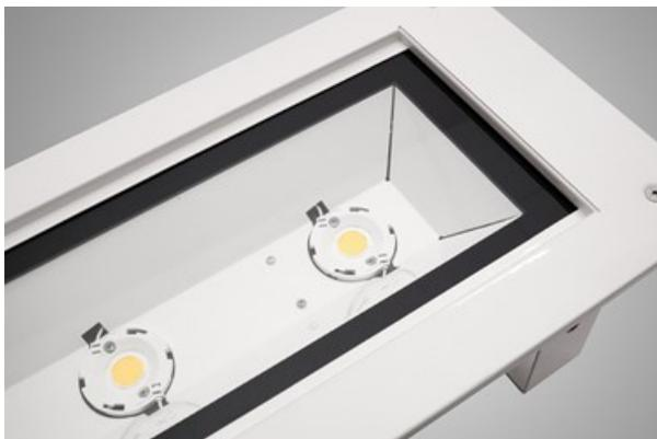
Außenbeleuchtung. Montage: Einbau in abgehängte Decken. Gehäuse aus Aluminium. Arbeitstemperaturbereich:  $-25 \div 40^\circ \text{C}$ . Stoßfestigkeitsgrad: IK08. Schutzklasse: I. Die externe Anwendung ist möglich, da das Produkt mit einem Druckausgleichsventil ausgestattet ist und das Gehäuse eine spezielle Lackierung aufweist, die an die äußeren Bedingungen angepasst ist.
