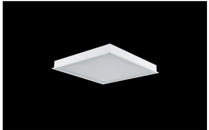
Innenbeleuchtung. Montage: Einbauleuchte für Deckenmontage. Gehäuse aus Stahlblech. Arbeitstemperaturbereich:  $5 \div 30^{\circ} \text{C}$ . Stoßfestigkeitsgrad: IK08. Schutzklasse: I. Abdeckung rahmenlos aus 4mm ESG-Einscheibensicherheitsglas-Scheibe, mit komfortablen Magnetverschlüssen. \*Ausgewählte Leuchtenvarianten sind mit ENEC-Zertifikat erhältlich.
