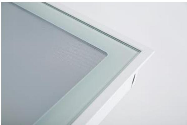
Innenbeleuchtung. Montage: Einbauleuchte für Deckenmontage. Gehäuse aus Stahlblech. Arbeitstemperaturbereich:  $5 \pm 30^\circ \text{C}$ . Stoßfestigkeitsgrad: IK08. Schutzklasse: I. Abdeckung rahmenlos aus 4mm ESG-Einscheibensicherheitsglas-Scheibe, mit komfortablen Magnetverschlüssen.
