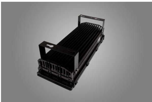
Außenbeleuchtung. Montage: Mastmontage; Anbau an der Decke oder an Aufhängebügeln. Gehäuse aus Aluminium. Arbeitstemperaturbereich:  $-25 \div 40^{\circ} \text{C}$ . Stoßfestigkeitsgrad: IK08. Schutzklasse: I. Die externe Anwendung ist möglich, da das Produkt mit einem Druckausgleichsventil ausgestattet ist und das Gehäuse eine spezielle Lackierung aufweist, die an die äußeren Bedingungen angepasst ist.
